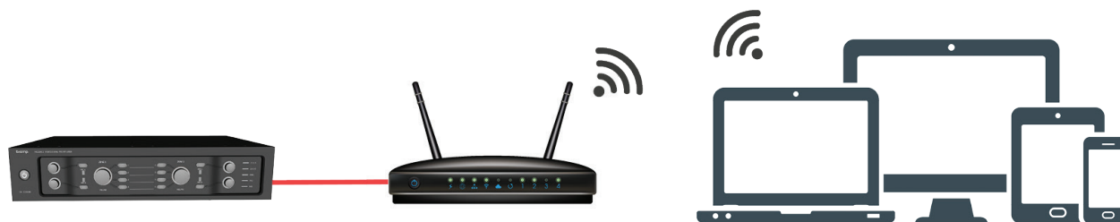
Рисунок 12. WiFi-подключение через маршрутизатор
