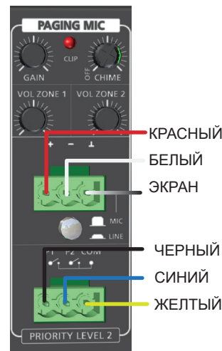
Рисунок 4а. Проводное соединение MICPAT-2
